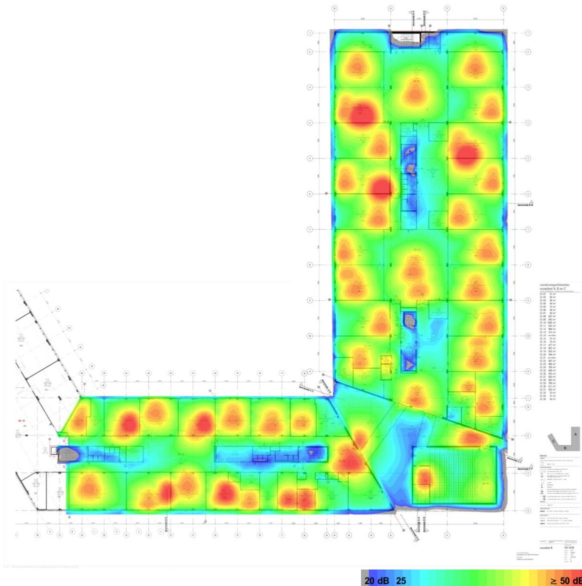
Figuur 5 – Signal-to-Noise Ratio (SNR), 1e verdieping
